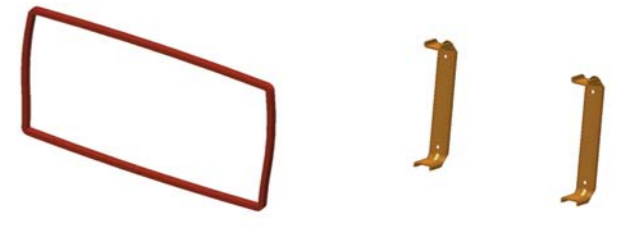
FIG. 6b Metal Brackets and Gasket-Staffe metalliche e guarnizione
