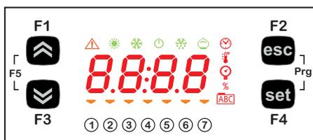
All'accensione, **FREE Smart** esegue un lamp test che verifica l'integrità e il buon funzionamento dello stesso.
