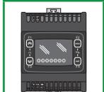
**SMC-SMD5500/C(S) / SME5500 (22 I/O)** è disponibile in varie versioni, in base alle quali si può disporre di 6 ingressi digitali, fino a 5 uscite relè, fino a 2 uscite TRIAC, fino a 2 uscite analogiche PPM/PWM, fino a 3 uscite analogiche 0...10 V/0... 20 mA/4...20 mA configurabili e fino a 2 uscite digitali Open Collector per un relè esterno.
