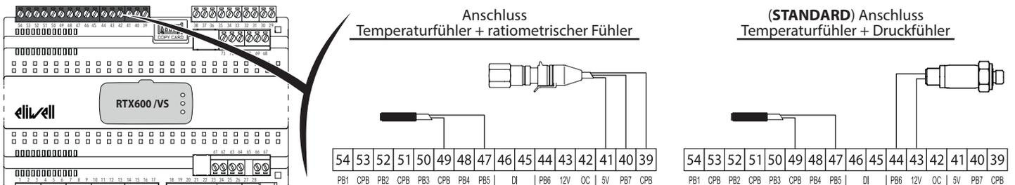
Im Netzwerk kann ein Sättigungsfühler an jedes Gerät angeschlossen werden (max. 8 Geräte):
