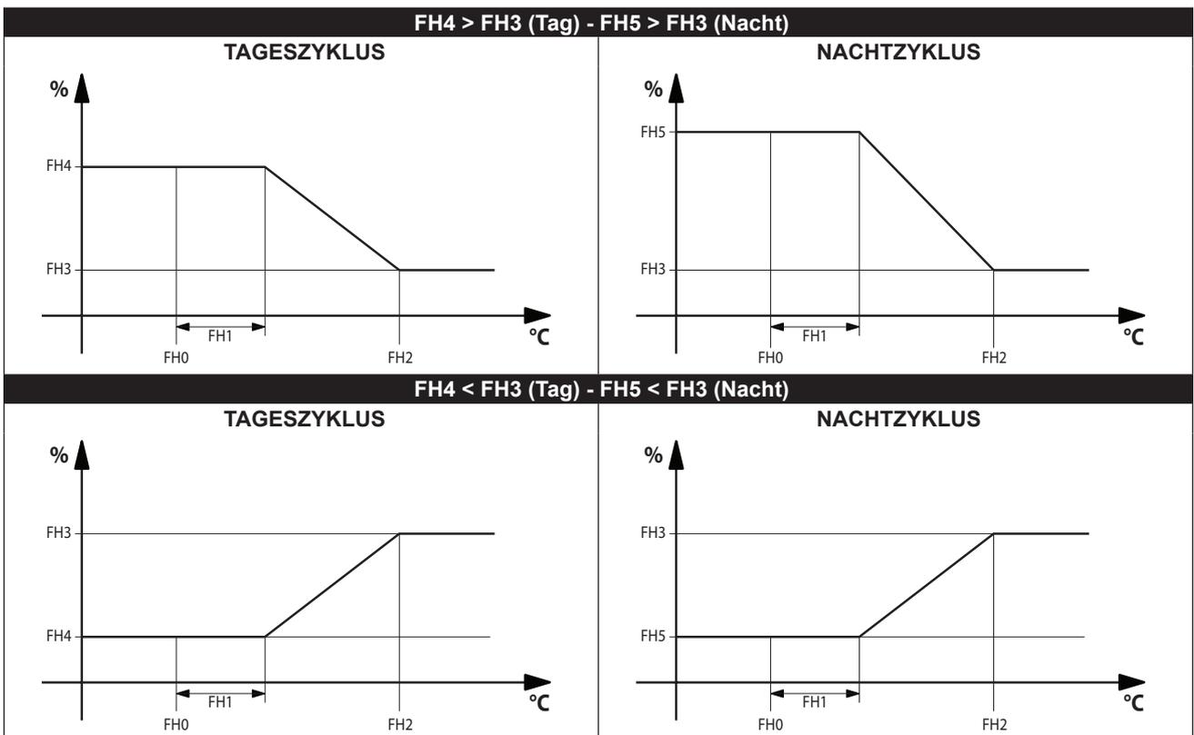
Die Modulation des Ausgangs ist von dem mit Parameter **FH0** eingestellten Wert des Taupunkts (Umgebung) abhängig.
