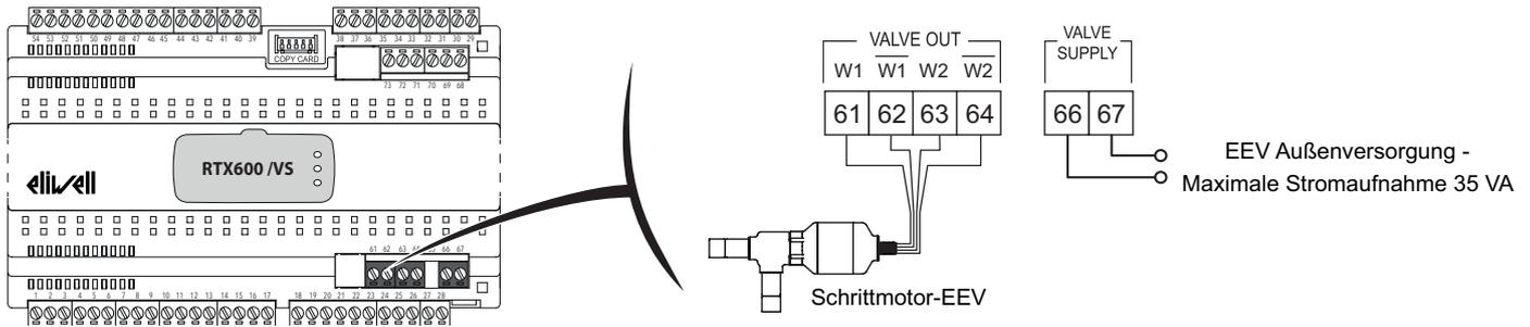
Konfigurieren Sie **RTX 600 /VS** durch Auswahl des Ventils unter den ansteuerbaren Ventilen vor dem Ventilanschluss.
