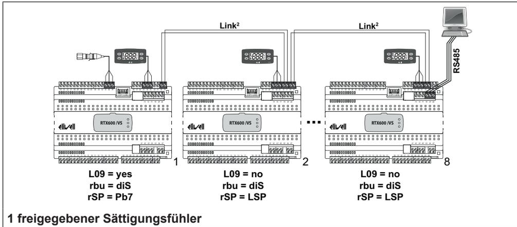
Im Netzwerk können zwei Sättigungsfühler für sämtliche Geräte im lokalen Netzwerk Link<sup>2</sup> (max. 8 Geräte) freigegeben werden, von denen einer als Backup-Fühler dient:
