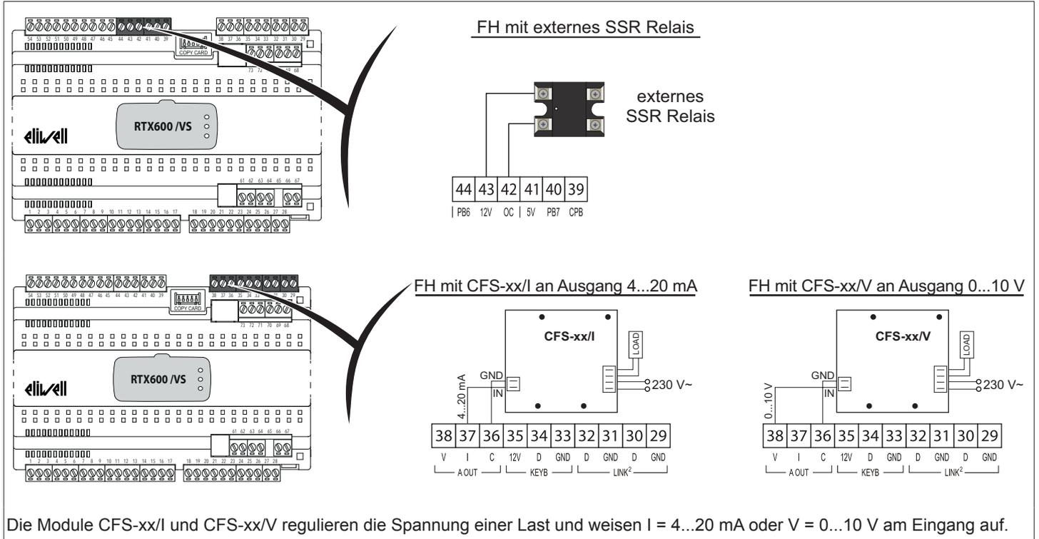
Die Module CFS-xx/I und CFS-xx/V regulieren die Spannung einer Last und weisen I = 4...20 mA oder V = 0...10 V am Eingang auf.
