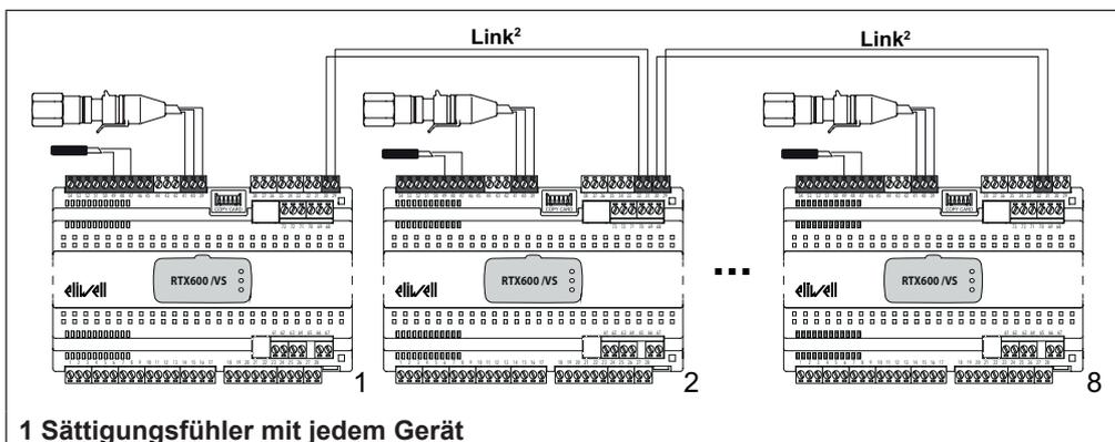
Im Netzwerk kann lediglich ein Sättigungsfühler für sämtliche Geräte im lokalen Netzwerk Link<sup>2</sup> (max. 8 Geräte) freigegeben werden:
