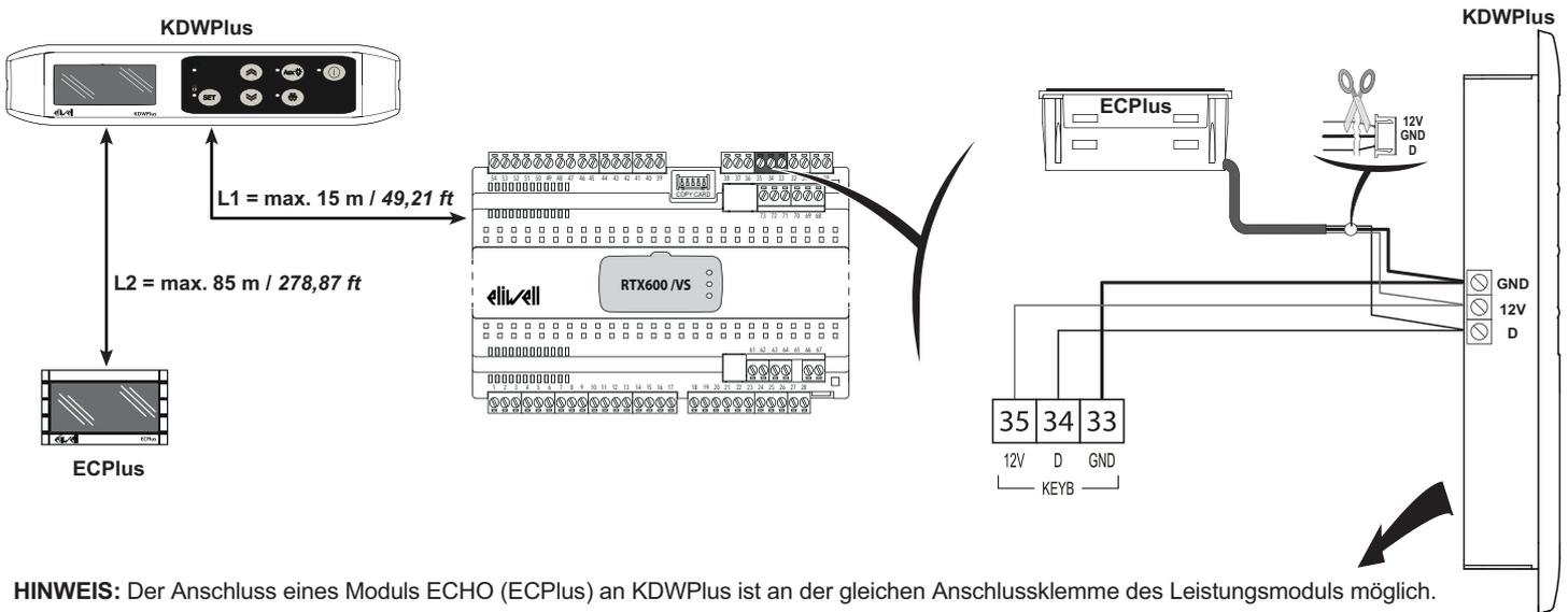
**HINWEIS:** Der Anschluss eines Moduls ECHO (ECPlus) an KDWPlus ist an der gleichen Anschlussklemme des Leistungsmoduls möglich.
